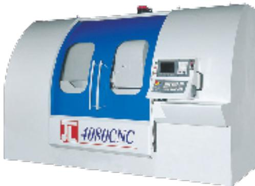
As principais estruturas das máquinas Joen Lih são feitas em ferro fundido FC30 de alta qualidade, que apresentam alta resistência com amortecimento de vibração. Os avançados servo motores controlam os fusos de esferas e as guias lineares das máquinas, resultando uma usinagem consistente de alta velocidade e resposta de precisão de alta frequência para garantir uma maior eficiência.
